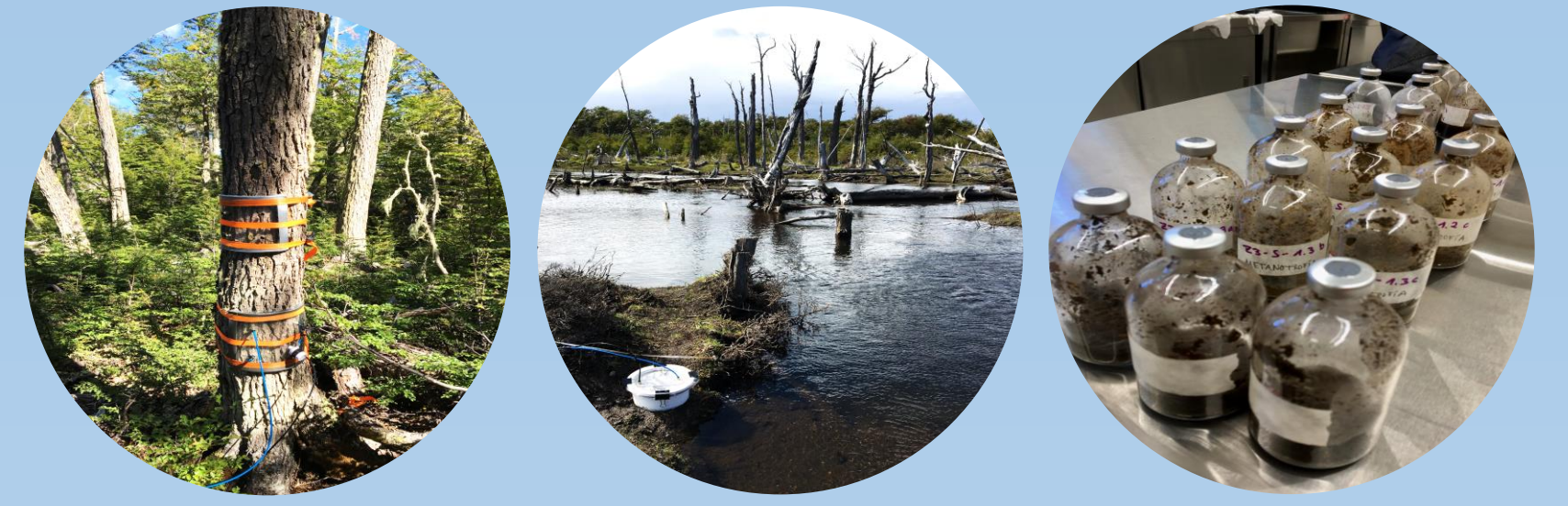
Medición de gases en a) troncos en el bosque conservado; b) suelos en la castorera; y c) incubaciones de CH 4 en laboratorio.
